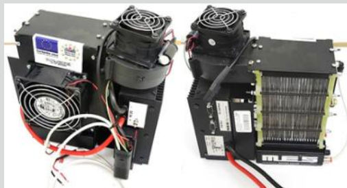
Palivový článok PEM a grafické rozhranie riadiaceho programu palivového článku
