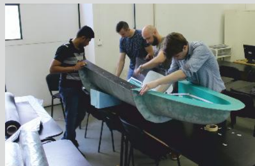
Príprava foriem pred výrobou karosérie vozidla
