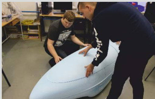
Finalizácia jednotlivých komponentov kopyta karosérie vozidla
