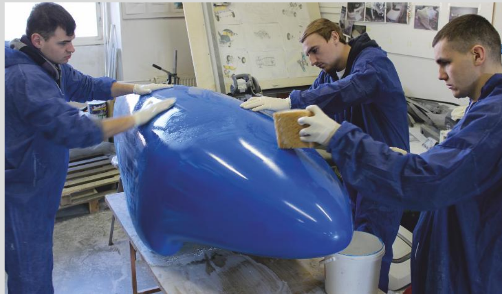
Úprava kopyta karosérie pred výrobou foriem
