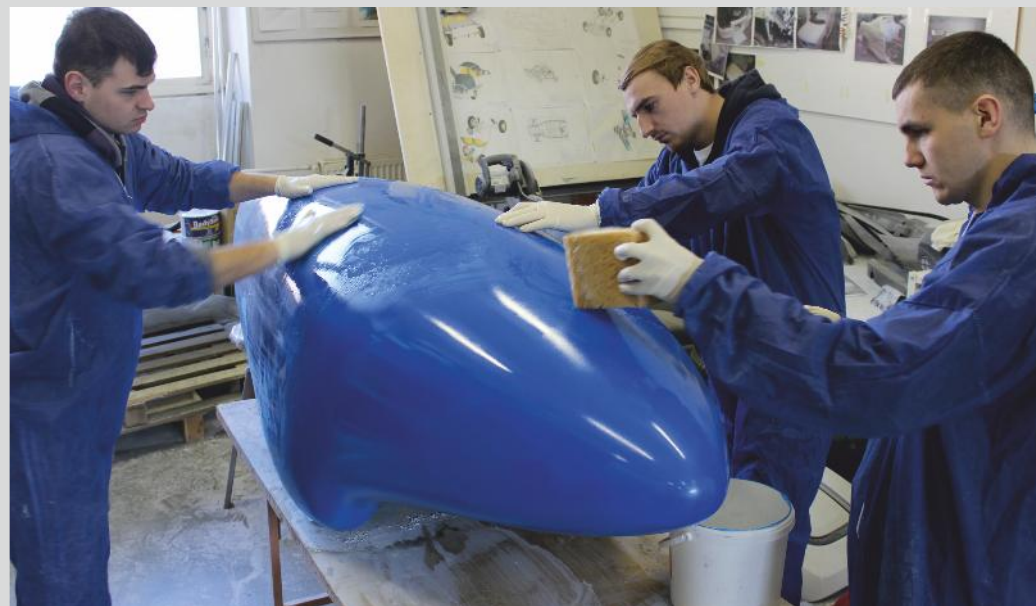
Úprava kopyta karosérie pred výrobou foriem
