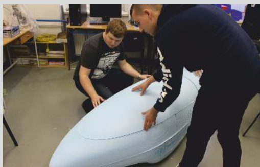
Finalizácia jednotlivých komponentov kopyta karosérie vozidla
