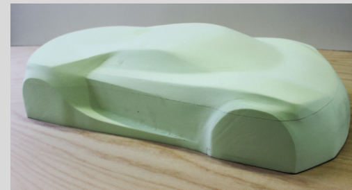
Kopyto karosérie elektromobilu po dokončení
