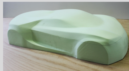
Kopyto karosérie elektromobilu po dokončení
