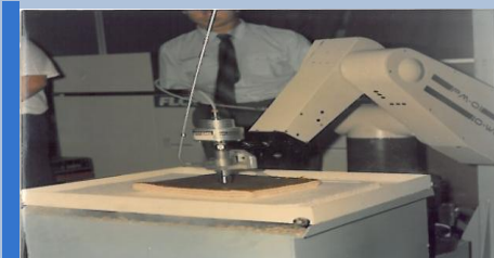
Robotizované pracovisko delenia potravinárskych výrobkov vodným lúčom, AGROKOMPLEX Nitra, 1988
