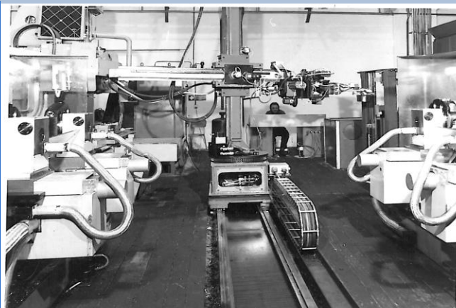
Automatizované pracovisko NC strojov s robotom AMF 600, realizované v ZŤS,n.p. Martin 1980
