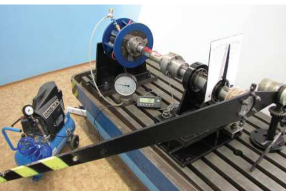
Meranie statických vlastností pneumatických spojok / Measurement of static characteristics of pneumatic couplings // Messungen der statischen Eigenschaften der Wellenkupplungen
