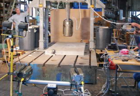
Experimentálna skúška modelu kontajnera C30 / Experimental testing of a C30 container model // Experimentalprüfung des Containermodells C30
