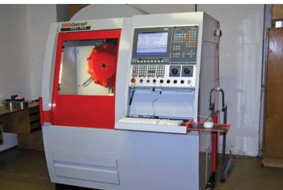
3-osová frézovačka s riadením Heidenhain - EmcoMill 155 / 3-axis milling machine with Heidenhain - Emco-Mill 155 control system // 3-Achsen-Fräsmaschine mit Heidenhain-Steuerung - EmcoMill 155
