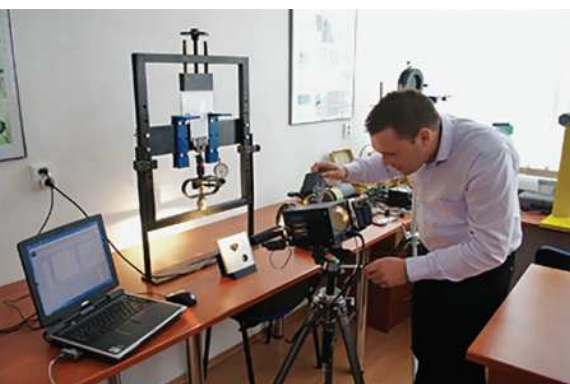
Kvantitatívna a kvalitatívna napätová analýza pomocou opticky citlivých materiálov / Quantitative and qualitative stress analysis using optically sensitive materials // Spannungsanalyse mit optisch empfindlichen Materialien
