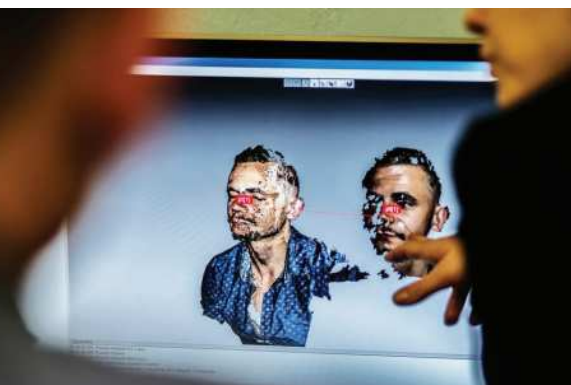
Spájanie skenov získaných ručným skenerom Artec Eva / Merging of scans taken by Artec Eva handheld scanner // Verbindung von Scans, die mit dem Handscanner Artec Eva gemacht worden sind
