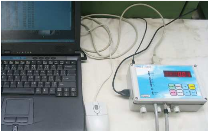
Tenzometer IPRE2-VZV3 pre hodnotenie tváriteľnosti plechov / IPRE2-VZV3 strain gauge for sheet metal forming evaluation // IPRE2-VZV3 Dehnungsmessstreifen für die Blechumformung
