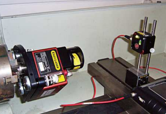
Meranie osového hádzania vretena sústruhu / Measurement of axial runout of the lathe spindle // eines Stirnlauffehlers der Drehmaschinespindel
