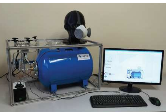
Zariadenie na meranie netesností líniou lícnicovej časti tvárovej polmasky / Device for measuring leaks in the facepiece of a face mask // Gerät zum Messen von Lecks im Gesichtsstück einer Gesichtsmaske
