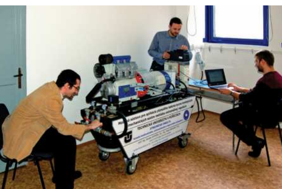
Sústava pre ladenie torzne kmitajúcich mechanických sústav / System for tuning of torsionally oscillating mechanical systems // Kontinuierliche Abstimmung der torsionsartig schwingenden mechanischen Systeme
