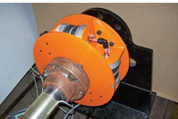
Pneumatický ladič torzných kmitov typu 4-70-T-C / Pneumatic tuner of torsional vibrations type 4-270-T-C // Pneumatischer Abtaster der Torsionsschwingungen Typ 4-270-T-C
