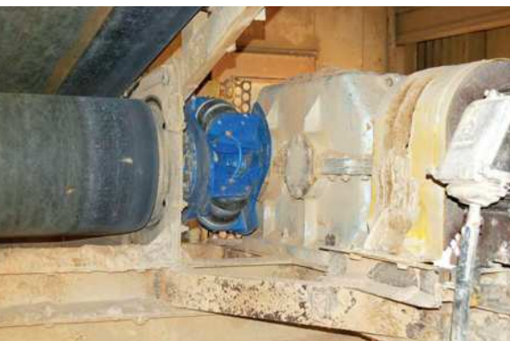
Aplikácia pneumatickej spojky vo firme Promag, Poľsko / Application of pneumatic coupling for the Promag company, Poland // Applikation der pneumatischen Wellenkupplung in der Firma Promag, Polen
