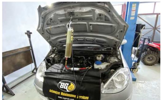
Dekarbonizácia sacieho priestoru / Decarbonisation of the intake manifold // Entkarbonisierung des Ansaugkrümmers
