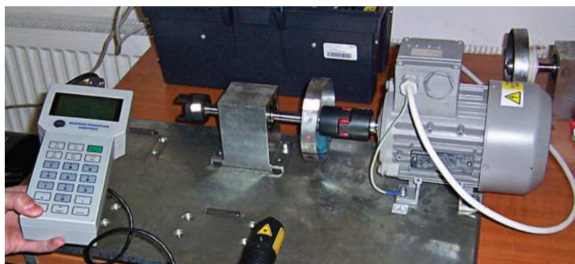
Meranie otáčok motora laserovou sondou (Adash) / Measurement of engine revolutions using laser probe (Adash) // Messung der Motordrehzahl mittels Lasersonde
