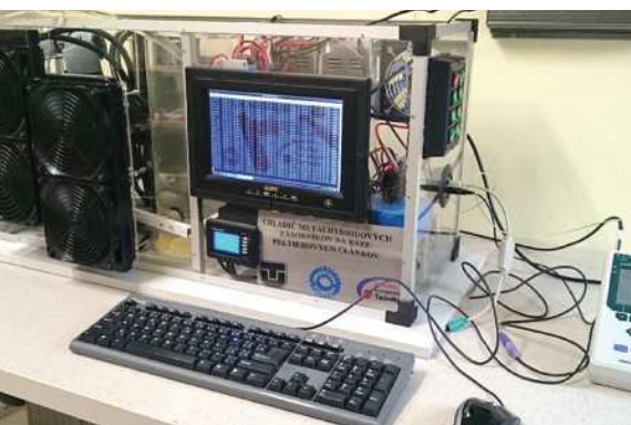
Prototyp zariadenia pre manažment MH zásobníkov / Prototype of the equipment for management of metal hydride storage tanks // Prototyp der Anlage für Management der MH-Speicher
