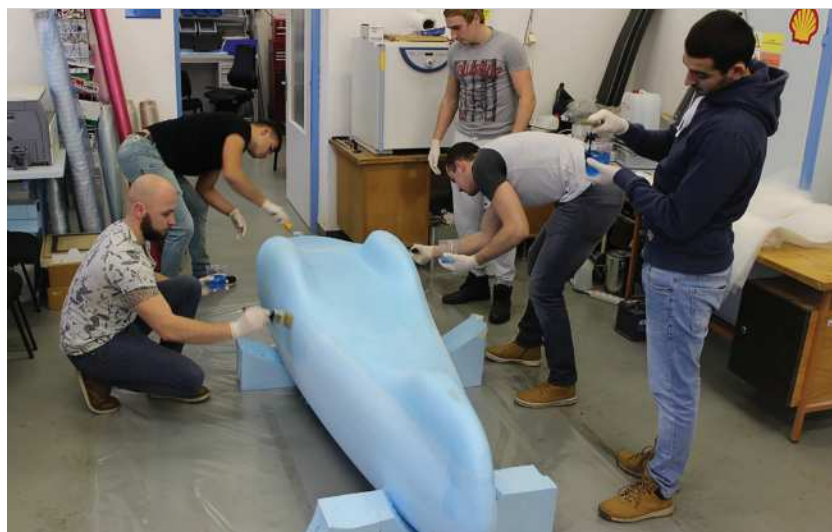
Laboratórium automobilovej výroby – príprava formy pre výrobu kompozitnej karosérie prototypu pre vozidlo Eco Shell / Laboratory of automotive production – mould preparation for composite body of the Eco Shell prototype vehicle //
