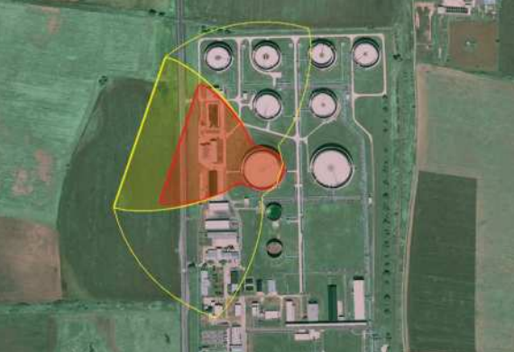
Modelovanie úniku toxickkej látky pre havarijnú plánovanie / Modelling of toxic substance leaks for the emergency planning // Modellierung der Freisetzung eines toxischen Stoffes für die Zwecke der Prävention bei störfallbedingten Planungen
