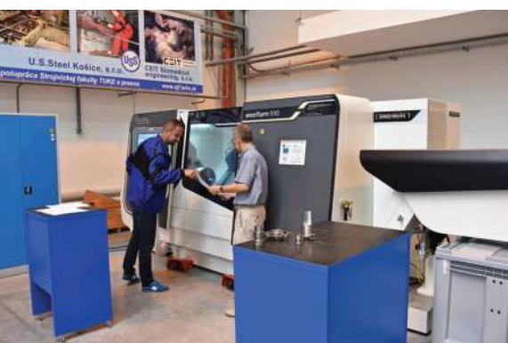
CNC sústružnícko-frézovacie centrum - konzultácia využitia prídavnej poháňanej osi / CNC Turning and Milling Centre – Consultation on additional driven axis utilisation // CNC Dreh- und Fräszentrum - Konsultation über die Verwendung einer zusätzlichen angetriebenen Achse
