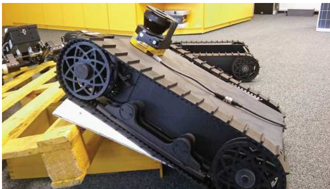
Pásový servisný robot s podvozkom typu Jaguar / Belt service robot with Jaguar type chassis // Raupen – Serviceroboter auf dem Fahrgestell des Typs Jaguar
