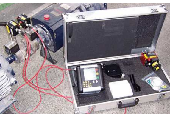
Meranie súosovosti hriadeľov / Measurement of shaft alignment // Messung der Achsenfluchtung der Wellen
