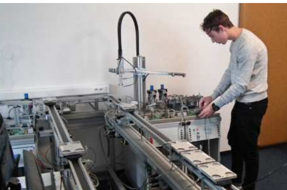
Nastavovanie synchronizácie periférií linky / Setting synchronization of the line peripherals // Einstellung der Synchronisierung von Peripherie der Produktionslinie
