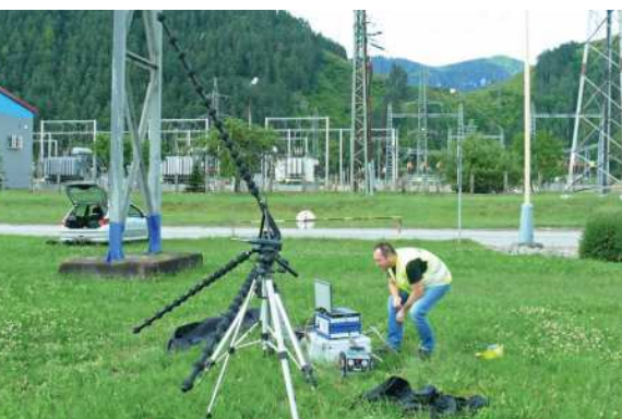
Meranie hluku akustickou kamerou / Measurement of noise by acoustic camera // Lärmmessung mit Akustikkamera
