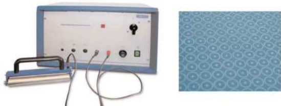
Zariadenie na nanášanie deformačnej siete - Erichsen 190D / Equipment for coating of the deformation area Erichsen 190D // Einrichtung für Auftragen von Deformationsnetz - Erichsen 190D
