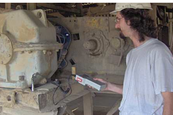
Analýza vibrácií pohonu pásového dopravníka aplikáciou pneumatickej spojky / Analysis of vibrations of the belt conveyor drive when applying a pneumatic coupling // Analyse der Antriebsvibrationen eines Förderbandes unter Einsatz der pneumatischen Wellenkupplung
