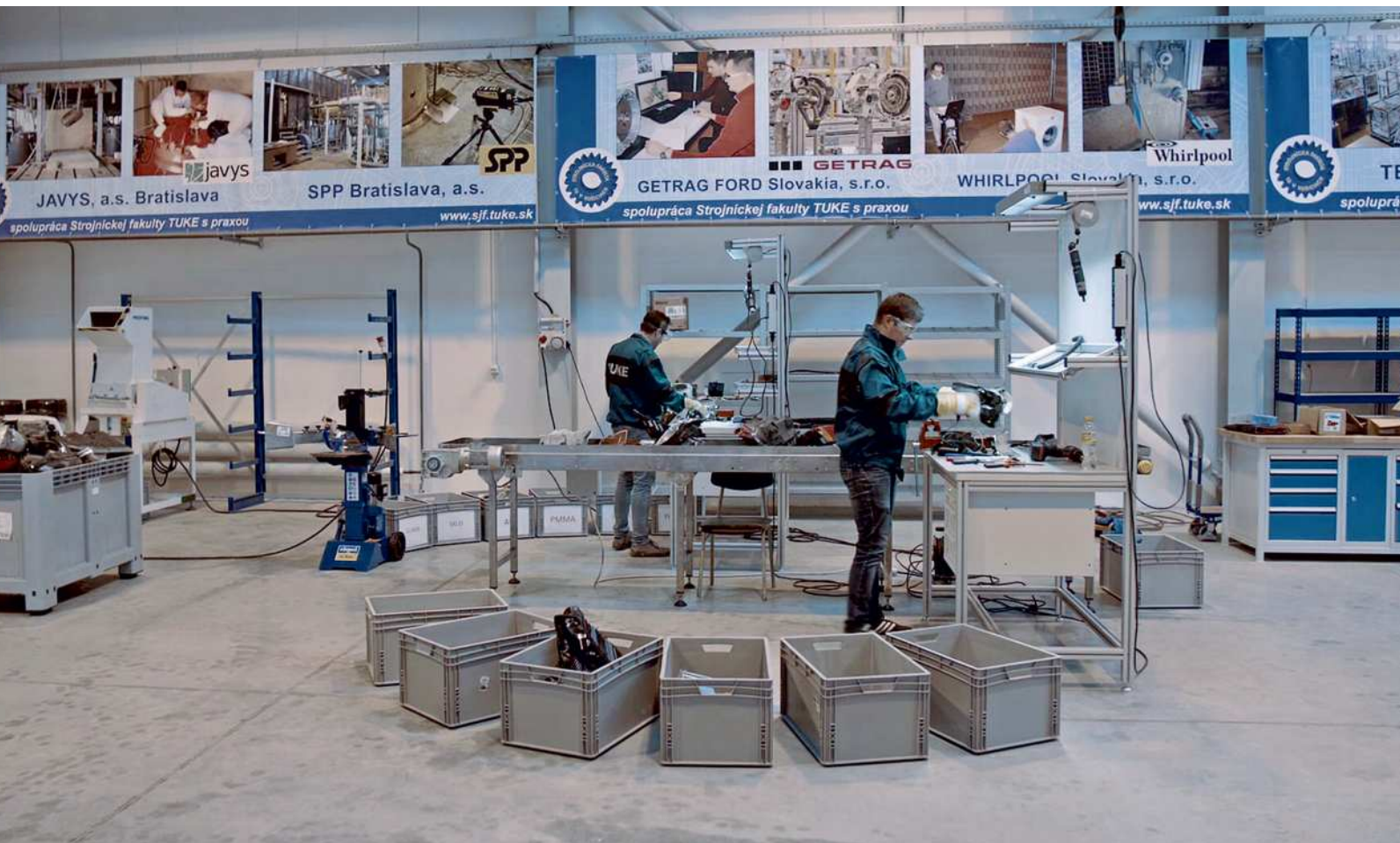
Demontážne pracovisko reflektorov automobilov / Facility for dismantling the automobile headlamps // Arbeitsstelle für Demontage von Automobilscheinwerfern
