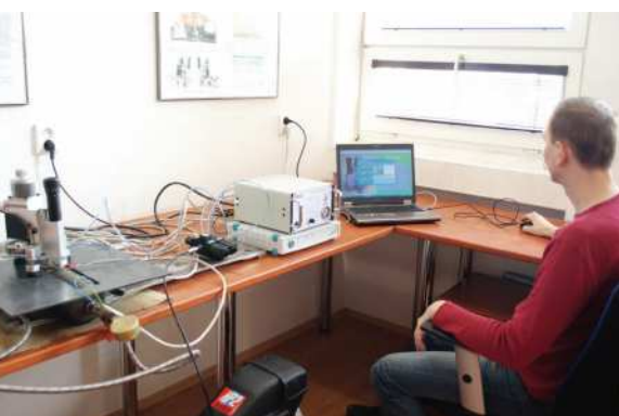
Meranie zvyškových napätí / Measurement of residual stresses // Messung der Restspannungen
