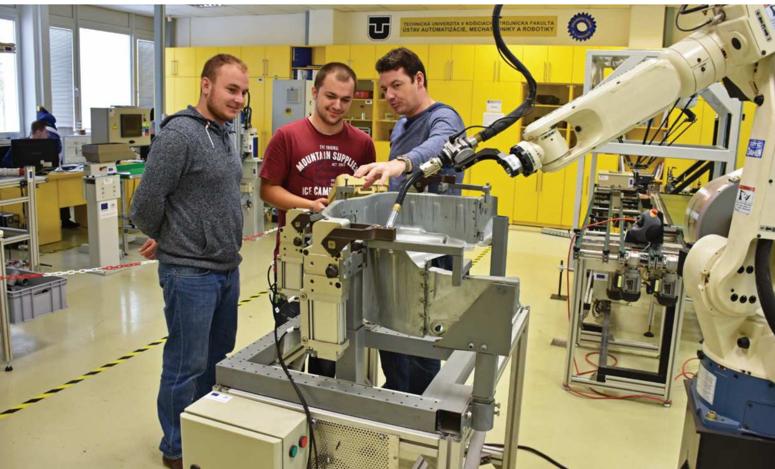
Robotizované pracovisko oblúkového zvarovania / Robotized facility of arc welding // Robotisierter Arbeitsplatz für Lichtbogenschweißen
