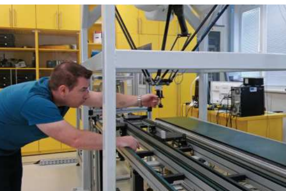
Nastavenie koncového efektora priemyselného robota / Adjusting the end effector of the industrial robot // Einstellung des Endeffektors eines Industrieroboters
