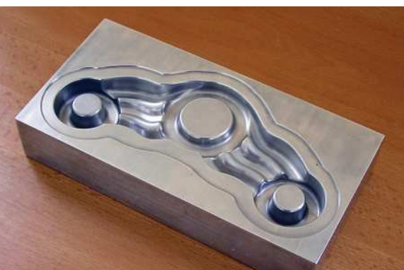
Kovacia zápustka vyrobená CNC frézovaním / A forging die made on a CNC milling machine // Schmiedegesenk hergestellt durch CNC-Fräsen
