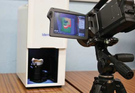
Snímanie teploty objektu termovíznou kamerou Flir SC660 / Scanning the object's temperature by Flir SC660 thermovisual camera // Messung der Objekttemperatur mit der Wärmebildkamera Flir SC660
