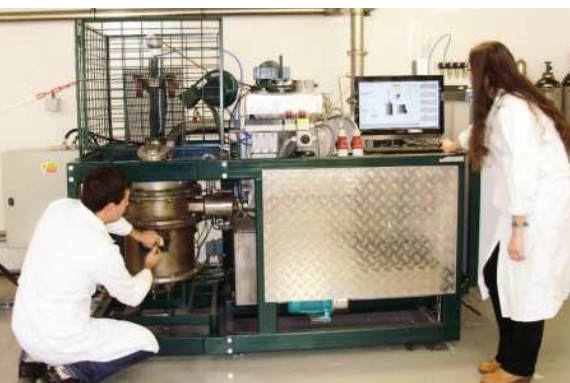
10 kVA laboratórny plazmový reaktor / 10 kVA laboratory plasma reactor // 10 kVA Laborplasmareaktor
