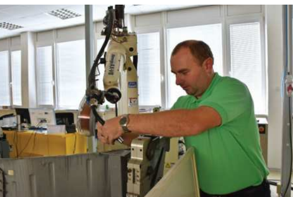
Konfigurácia snímača efektoru priemyselného robota / Configuration of the effector sensor in an industrial robot // Konfiguration des Effektorsensors für den Industrieroboter
