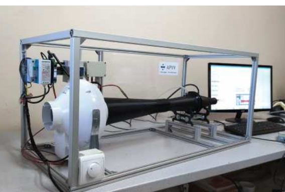
Zariadenie na meranie tlakových strát filtračných a poréznych materiálov / Device for measuring the pressure loss of the filter and porous materials // Geräte zur Messung von Druckverlusten von Filter- und porösen Materialien
