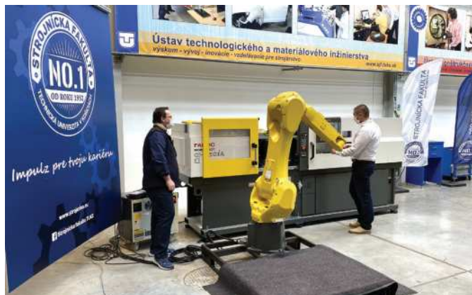
Aplikácia robotickej obsluhy vstrekovacieho lisu / Application of robotic operation of an injection molding machine // Anwendung der Roboterbedienung einer Spritzgießmaschine
