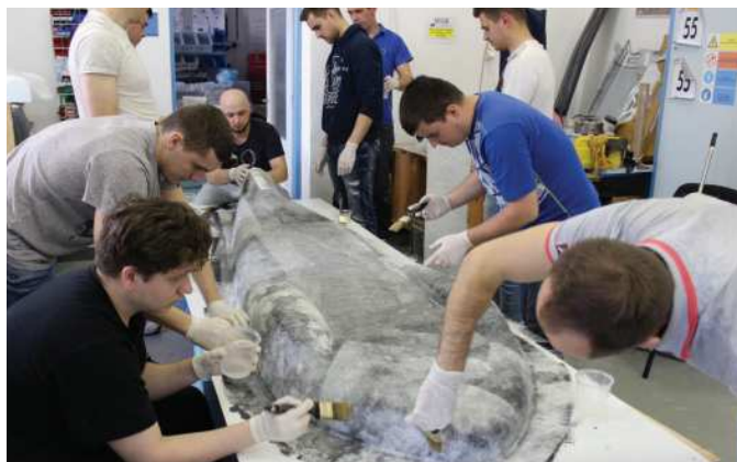
Výroba kompozitnej formy / Production of a composite mold // Fertigung der Verbundwerkstoffform
