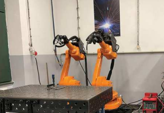
Zváračky roboty ABB, MIG/MAG zváračky Fronius Trans Synergic 4000 / ABB welding robots, MIG / MAG welding machines Fronius Trans Synergic 4000 // ABB Schweißroboter, MIG / MAG Schweißgeräte Fronius Trans Synergic 4000
