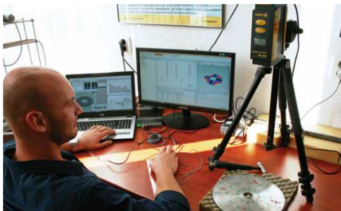
Meranie modálnych parametrov rezného kotúča pomocou laserového vibrometra / Measurement of modal parameters of the cutting disc by laser vibrometer // Messung der Modalparameter einer Scheidscheibe mittels Laservibrationsmeter
