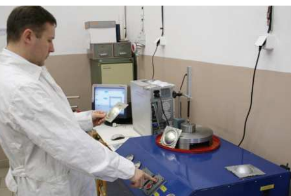
Skúška plechov vybul'ovaním - BULGE – hydrotest / Sheet metal testing by hydraulic bulging - BULGE – hydrotest // Blechprüfung durch BULGE-Hydrotest
