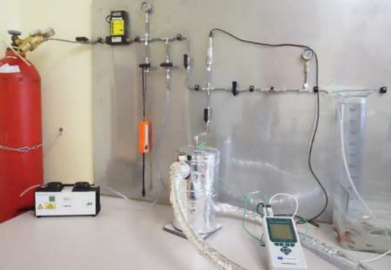
Stend pre volumetrické stanovovanie koncentrácie uloženého vodíka / Volumetric determination of the concentration of stored hydrogen // Stand für volumetrische Bestimmung der Konzentration des gespeicherten Wasserstoffes
