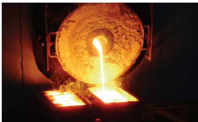
Odťah taveného odpadu / Tapping of molten scrap // Abstich der Schmelzabfallstoffe
