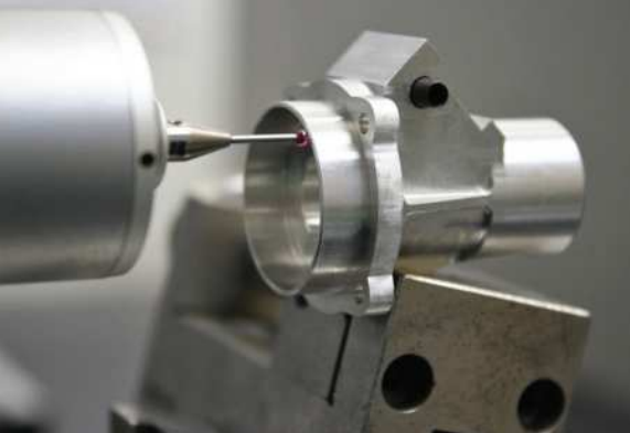
Meranie súčiastky na súradnicovom meracom stroji ZEISS Contura G2 / Measuring the component by ZEISS Contura G2 coordinate measuring machine // Messung eines Teiles mit dem Koordinatenmessgerät ZEISS Contura G2
