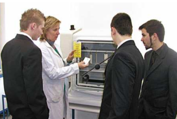
Kondenzačná komora – Liebisch KBEA 300 / Condensation chamber – Liebisch KBEA 300 // Kondensationsskammer – Liebisch KBEA 300
