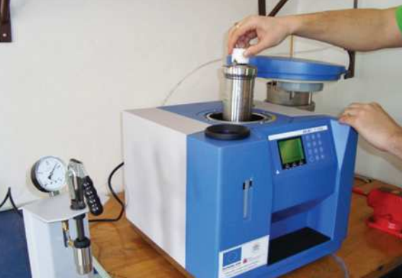
Automatický izoperibolický kalorimeter C 200 / C 200 automatic isoperibolic calorimeter // Automatischer isoperibolischer Kalorimeter C 200
