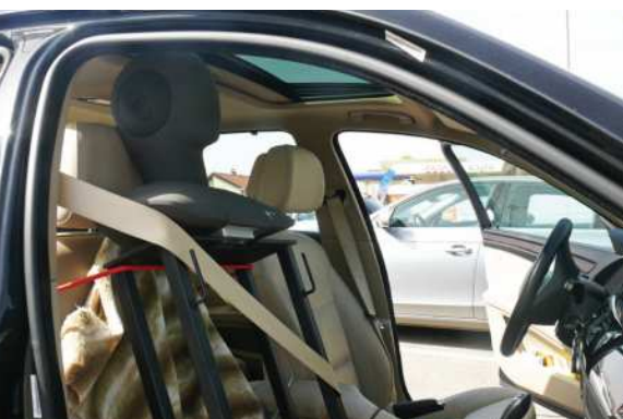
Meranie psychoakustických deskriptorov / Measurement of psychoacoustic descriptors // Messung der psychoakustischen Deskriptoren
