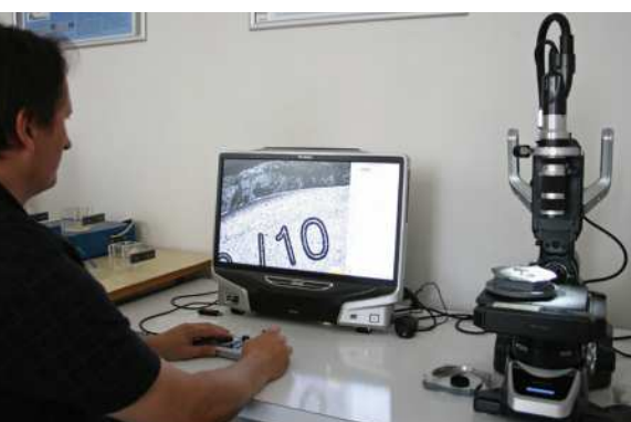
Digitálny mikroskop – Keyence VHX-5000 / Digital microscope – Keyence VHX-5000 // Digitales Mikroskop – Keyence VHX-5000
