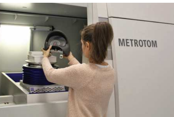
Tomograf ZEISS Metrotom 1500 - príprava na skenovanie / ZEISS Metrotom 1500 tomograph - preparation for scanning // Computertomograph ZEISS Metrotom 1500 und die Vorbereitung für das Scannen
