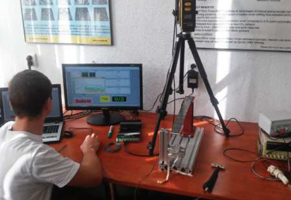
Meranie kmitania laserom pomocou prístroja Polytec / Measurement of vibration by Polytec laser vibrometer // Schwingungsmessung mittels Laser mit dem Gerät Polytec
