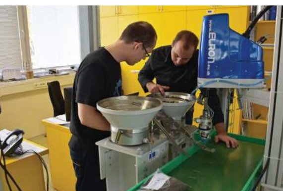
Pracovisko s robotom SCARA a kamerovým systémom / Workplace with SCARA robot and a camera surveillance system // Arbeitsplatz mit dem Roboter SCARA und dem Kamerasystem
