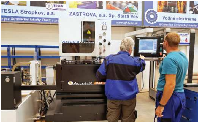
CNC drôtová rezačka - výroba vysoko presných nástrojov / CNC EDM Wire Cut Machine – high precision tools manufacture // CNC EDM Drahtschneidemaschine - Herstellung von Hochpräzisionswerkzeuge
