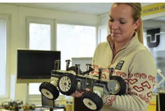
Experimentálny model šesťkolesového servisného robota / Experimental model of six-wheel service robot // Experimentelles Modell eines Sechs-Rad-Serviceroboters
