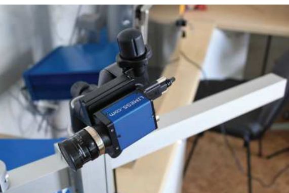
Optický extenzometer ako súčasť skúšobného stroja Hegewald & Peschke / Optical extensometer as part of Hegewald & Peschke testing machine // Optischer Extensometer als Bestandteil des Prüfgeräts von Hegewald & Peschke
