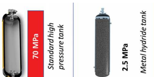
Porovnanie tlaku v H 2 zásobníkoch / Comparison of pressure in H 2 reservoirs // Druckvergleich in H 2 -Lagerstätten
