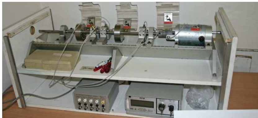
Stend pre vykonávanie vibrodiagnostických meraní točivých strojov / Equipment for vibrodiagnostic measurement of rotating machines // Stend für die Realisierung von vibrodiagnostischen Messungen bei Rotationsmaschinen
