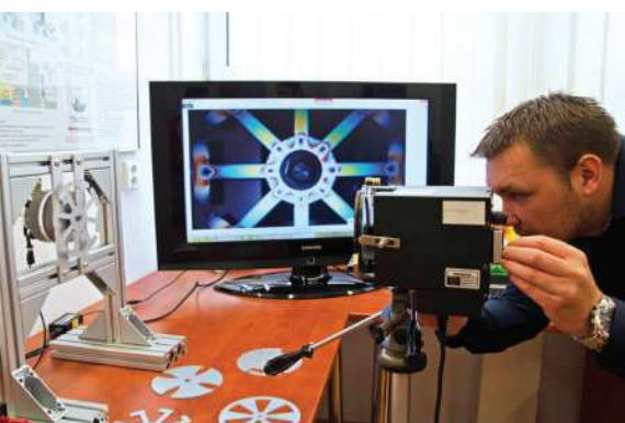
Využitie stroboskopu pri reflexnej fotoelasticimetrii / Application of stroboscope in reflective photoelasticimetry // Nutzung des Stroboskops bei der reflexen Fotoelastizimetrie
