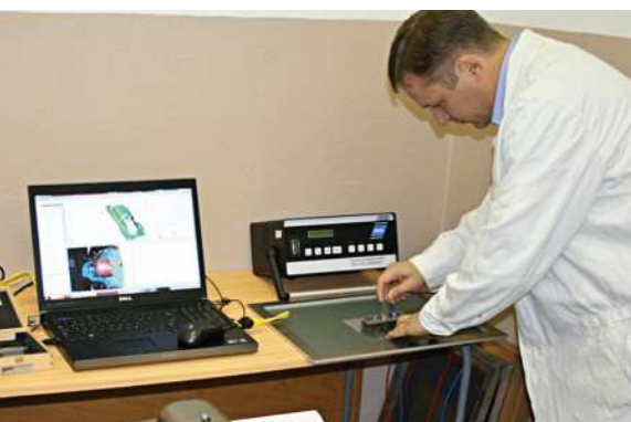
Nanášanie deformačnej siete elektrochemickým leptaním / Application of a deformation grid by electrolytic etching // Auftragen des Deformationsnetzes durch elektrochemische Ätzung
