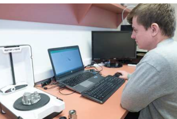
Reverzné inžinierstvo - pracovisko s 3D skenerom Matterform / Reverse engineering - workplace with Matterform 3D scanner // Reverse-Engineering (Nachkonstruktion) – Arbeitsplatz mit 3D-Scanner Matterform
