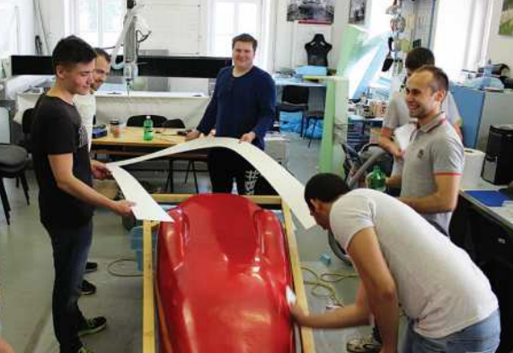
Výroba kompozitnej formy karosérie / Production of a car body composite form // Fertigung der Verbundwerkstoffform der Karosserie
