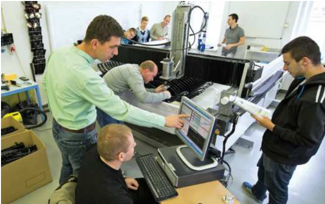
Validácia NC programu v softvéri Mach3 / Validation of NC program in Mach3 software // Validierung des NC-Programms mit der Software Mach 3
