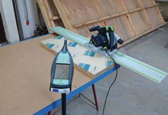
Meranie expozície hluku na pracovisku / Measurement of noise exposure in the workplace // Messung der Geräuschexposition am Arbeitsplatz
