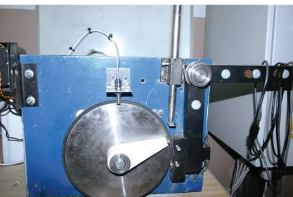
Tribometer na výskum abrazívneho opotrebenia / Tribometer for the analysis of abrasive wear // Tribometer zur Erforschung von abrasivem Verschleiß
