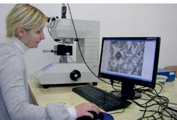
Meranie mikro tvrdosti - Shimadzu HMV-2 / Micro hardness tester - Shimadzu HMV-2 // Messung der Mikrohärtigkeit – Shimadzu HMV-2
