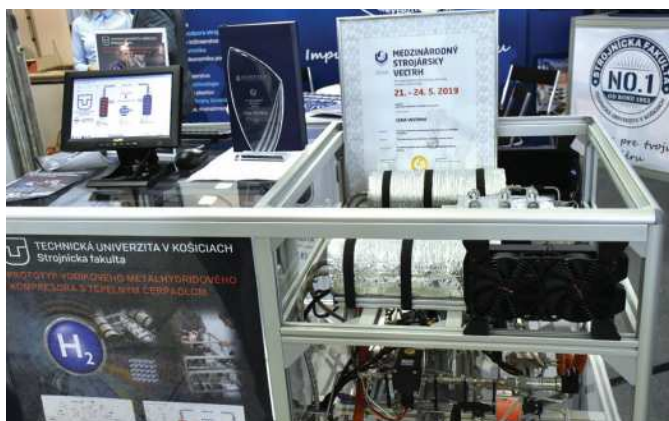
Kompresor vodíka na báze metalhydridových zliatin ocenený na 26. MSV v Nitre 2019 / Wasserstoffkompressor auf Basis von Metallhydridlegierungen // Wasserstoffkompressor auf Basis von Metallhydridlegierungen
