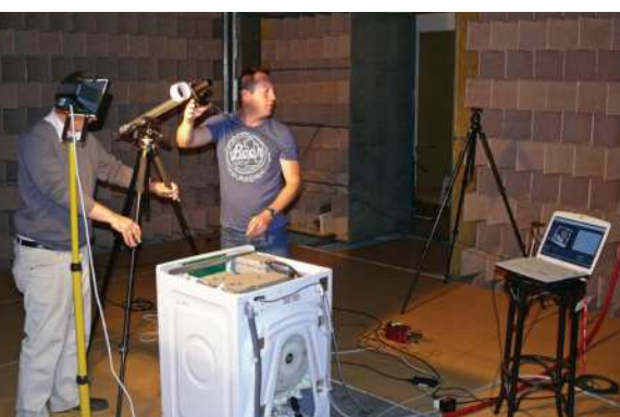
Meranie hluku v bezdovukovej komore / Measurement of noise in the anechoic chamber // Lärmmessung in der schalltoten Kammer
