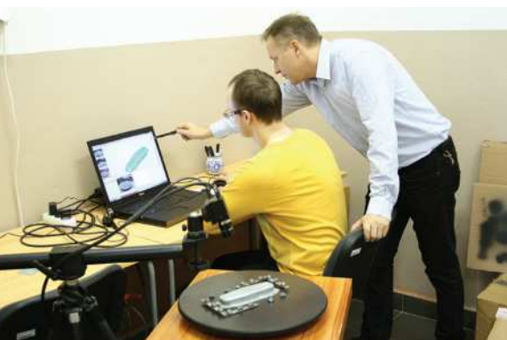
Optické hodnotenie deformácií na výlisku – ARGUS / Optical evaluation of deformations of formed parts – ARGUS // Optische Bewertung der Verformung von Presteilen – ARGUS
