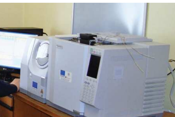
Plynový chromatograf s hmotnostným spektrometrom / Gas chromatograph with mass spectrometer // Gaschromatograph mit Gewichtsspektrometer
