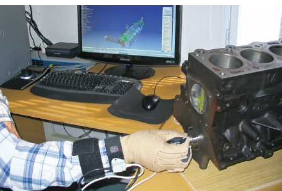
Dátová rukavica CyberGlove II a digitálny model vo virtuálnom prostredí / Cyber Data Glove II and a digital model in virtual reality // Datenhandschuh Cyber Glove II und digitales Modell in der virtuellen Umgebung
