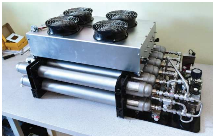
Vodíkový uskladňovací systém s palivovým článkom pre nasadenie do automobilu / Hydrogen storage system with fuel cell for use in a car // Wasserstoffspeicher mit Brennstoffzelle für den Einsatz im Auto
