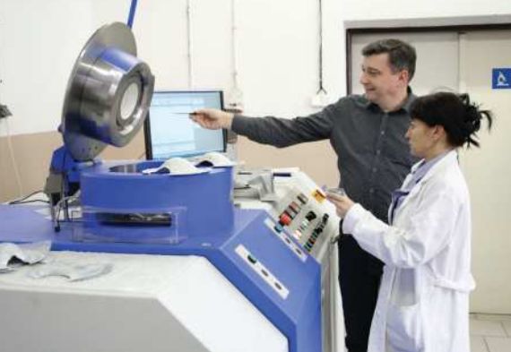
Skúška hlbokotažnosti – ERICHSEN 145-60 / Deep drawing testing – ERICHSEN 145-60 // Tiefziehprüfung – ERICHSEN 145-60
