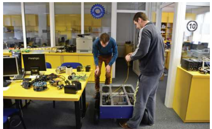
Montáž podvozku servisného robota / Service robot chassis assembly // Montage des Fahrgestells eines Serviceroboters
