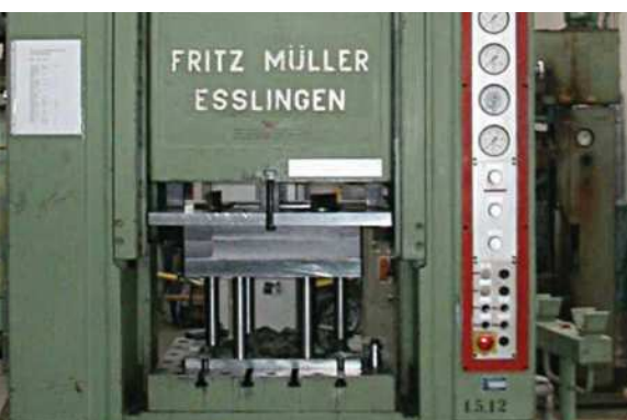
Dvojčinný hydraulický lis - Fritz Muller BZE100 / Dual action hydraulic press - Fritz Muller BZE100 // Doppel-twirkende hydraulische Presse - Fritz Muller BZE100
