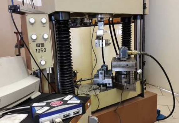
Tenzometrická aparátúra - Quantum MX440 / Tensometric apparatus - Quantum MX440 // Tensometrische Apparatur – Quantum MX440
