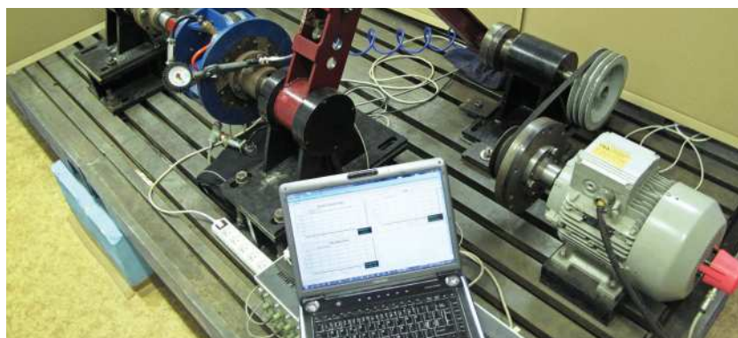
Meranie dynamických vlastností pneumatických spojok / Measurement of dynamic properties of pneumatic couplings // Messungen der dynamischen Eigenschaften der Wellenkupplungen
