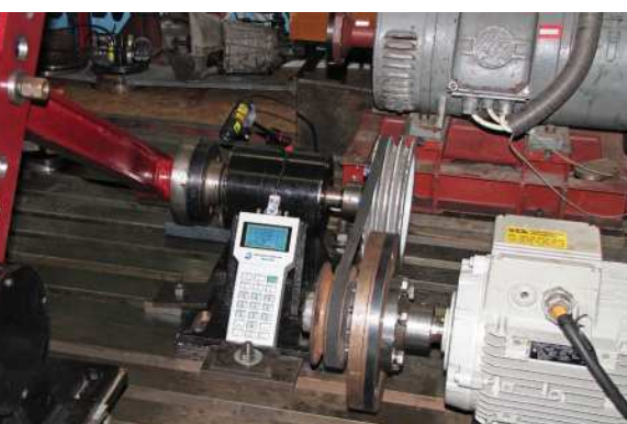
Snímanie otáčok vstupného člena 4-kĺbového mechanizmu / Speed measurement of the input element of a 4-hinged mechanism // Drehzahlmessung des Eingabemitglieds des 4-Gelenkmechanismus
